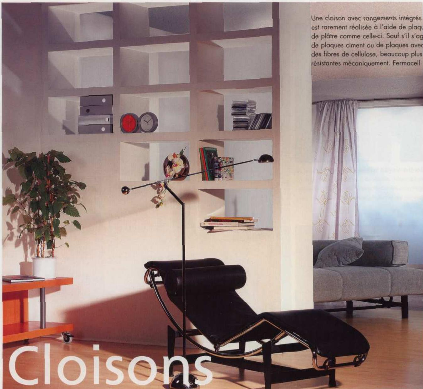
Une cloison avec rangements intégrés est rarement réalisée à l'aide de plaques de plâtre comme celle-ci. Sauf s'il s'agit de plaques ciment ou de plaques avec des fibres de cellulose, beaucoup plus résistantes mécaniquement. Fermacell
