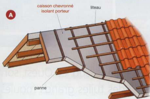
A. Les panneaux isolants porteurs se posent bord à bord avec rainures et languettes. Ce qui évite un pont thermique au niveau des joints. Le contre-lattage est fixé en usine ou sur place. Doc. Promo PSE. – B. Appelé « sarking », cette méthode autorise une isolation sur mesure en posant une deuxième couche de panneaux. Doc. Isover.
